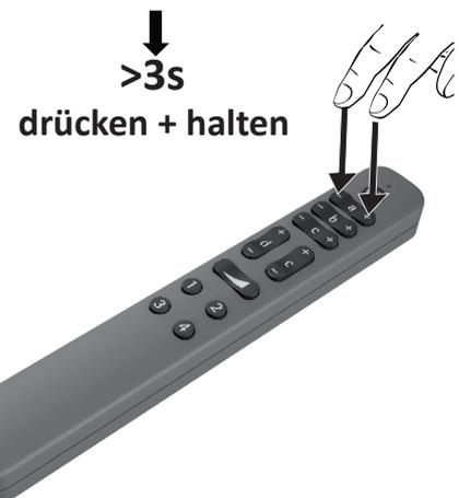
Der erfolgreiche Start wird mit schnellem Blinken der roten Anzeige-LED bestätigt. Bei gelungener Anbindung blinkt die Rote LED 6 Mal. Die erfolgreiche Verbindung wird auch durch Blinken der angeschlossenen LED Leuchte bestätigt.
